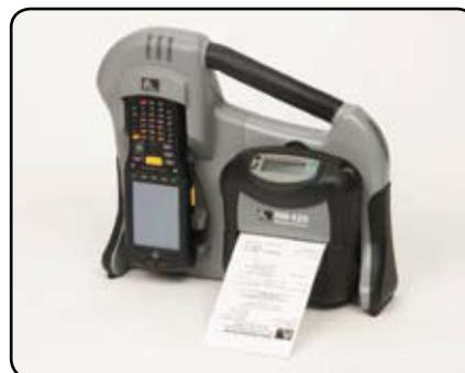
Route Palette RW 420 di Zebra fornisce un pratico alloggiamento combinato per la stampante portatile RW 420 di Zebra e per un computer palmare Motorola MC70, MC75, MC9090-S ("short"), MC9094, MC9097 o MC9500.
