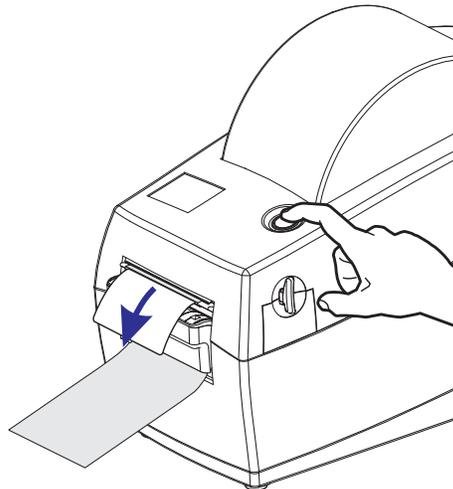
6. Nel corso dell'operazione di stampa, la stampante staccherà il supporto e presenterà un'etichetta singola. Prendere l'etichetta dalla stampante, in modo che possa passare alla stampa dell'etichetta successiva. Nota: se il sensore di prelievo dell'etichetta non viene attivato tramite comandi software, verranno stampate più etichette senza pellicola di supporto.
