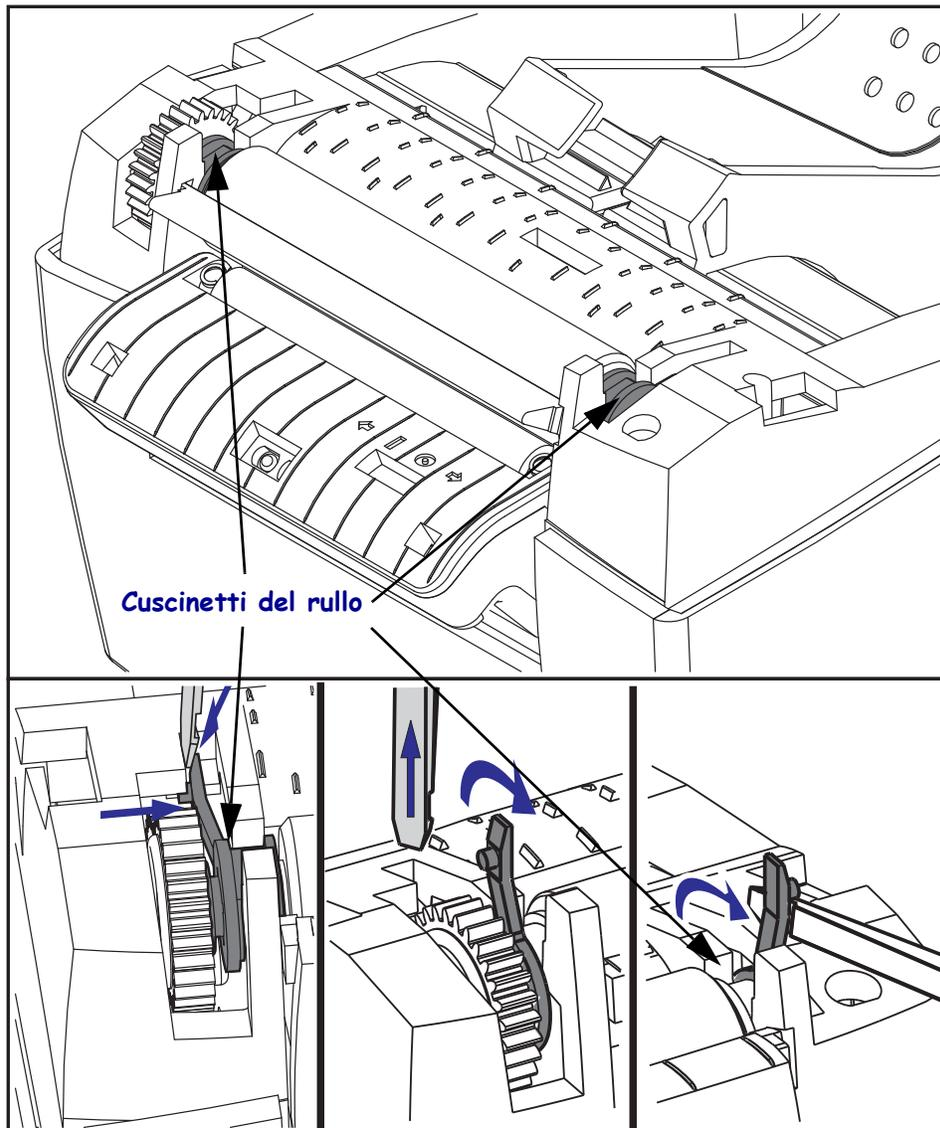
3. Sollevare il rullo dalla parte inferiore del telaio della stampante.
