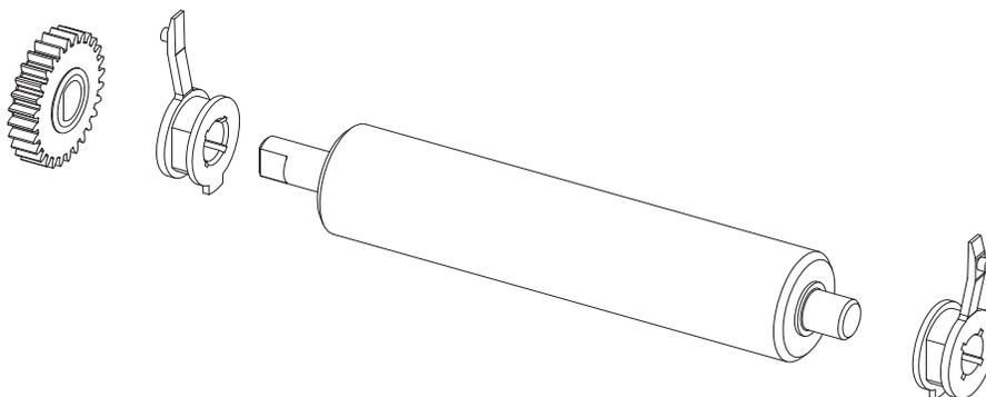
7. Allineare il rullo con l'ingranaggio a sinistra e inserirlo nella parte inferiore del telaio della stampante.
