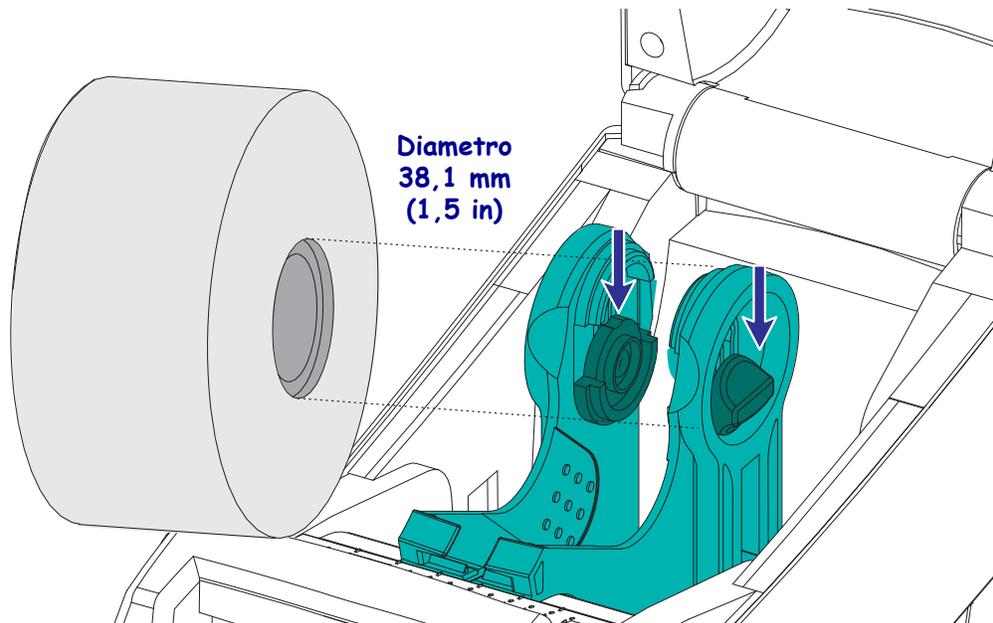
3. Aprire i supporti rotolo. Aprire le guide dei supporti con la mano libera, inserire il rotolo sui supporti e rilasciare le guide. Orientare il rotolo di supporti in modo che la superficie stampabile sia rivolta verso l'alto al passaggio sopra il rullo.
